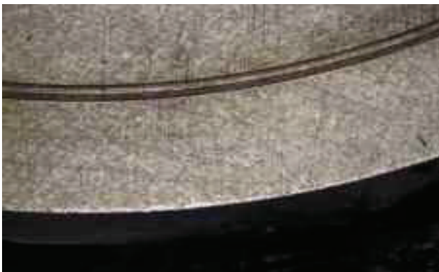
Einlaufrille nach 24 Stunden Run-in groove after 24 hours
