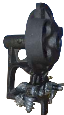
Вязальный аппарат, в сборе (вал привода Ø 32 мм)
